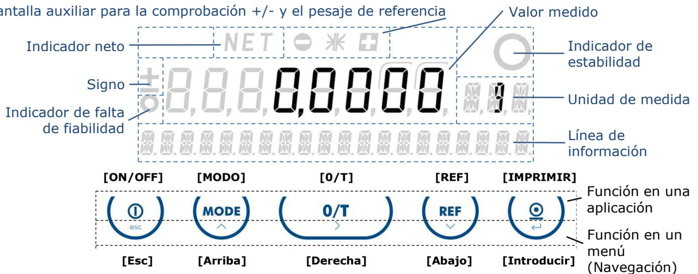
El valor medido es estable en cuanto se apagan todos los segmentos del indicador de estabilidad. El indicador de falta de fiabilidad se enciende mientras la balanza está recalculando el peso de referencia de referencia, por ejemplo, durante el conteo, o cuando es verificada y en fase de calentamiento.
