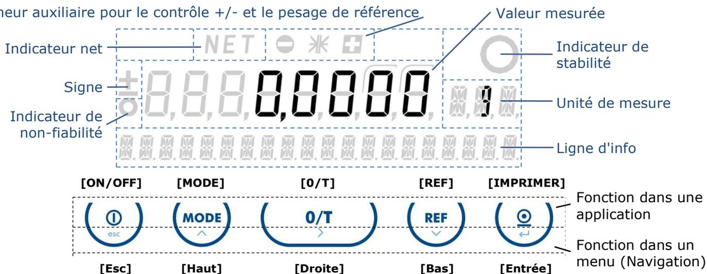
La valeur mesurée est stable dès que tous les segments de l'indicateur de stabilité s'éteignent. L'indicateur de non-fiabilité s'allume pendant que la balance recalcule le poids de référence, par exemple pendant le comptage, ou lorsqu'elle est en métrologie légale et en phase de préchauffage.
