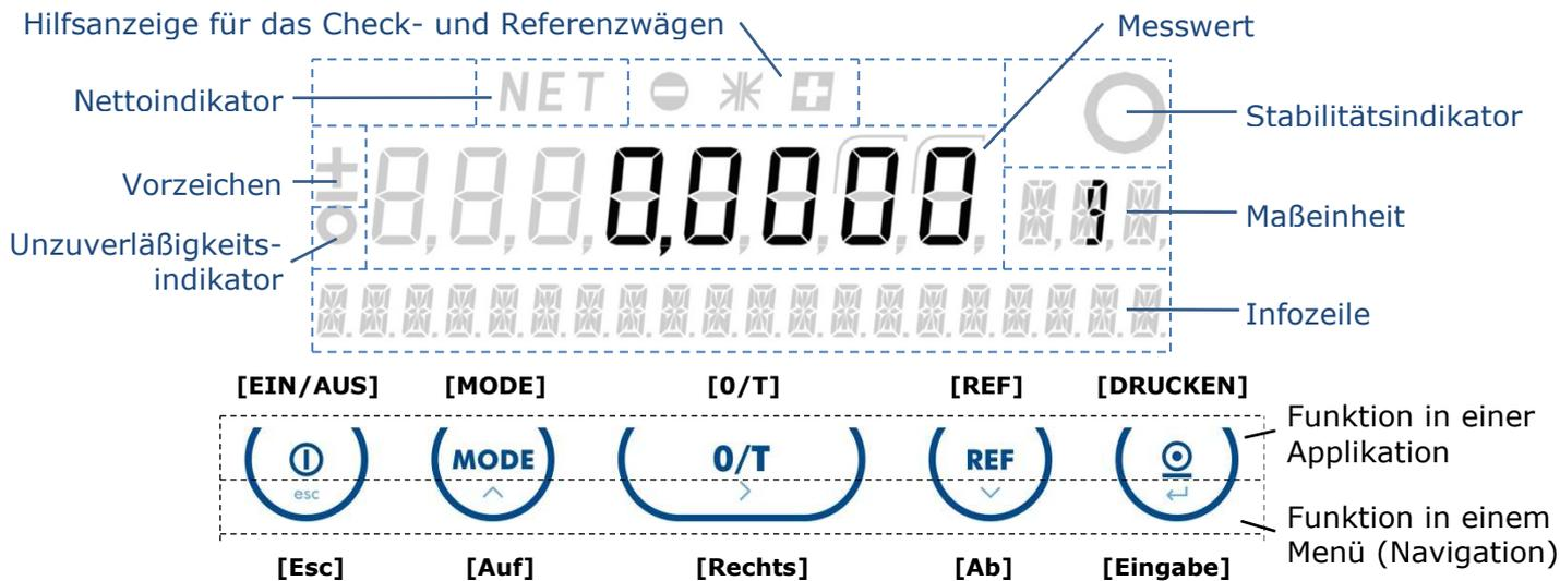
Der Messwert ist stabil, sobald alle Segmente des Stabilitätsindikators erlöschen. Der Unzuverlässigkeitsindikator leuchtet auf, während die Waage z.B. beim Zählen die Referenzstückzahl neu berechnet, oder wenn sie geeicht ist und sich in der Aufwärmphase befindet.
