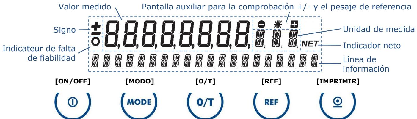
El valor medido es estable en cuanto aparece la unidad, por ejemplo, "g". El indicador de falta de fiabilidad se enciende mientras la balanza está recalculando el peso de referencia de referencia, por ejemplo, durante el conteo, o cuando es verificada y en fase de calentamiento.
