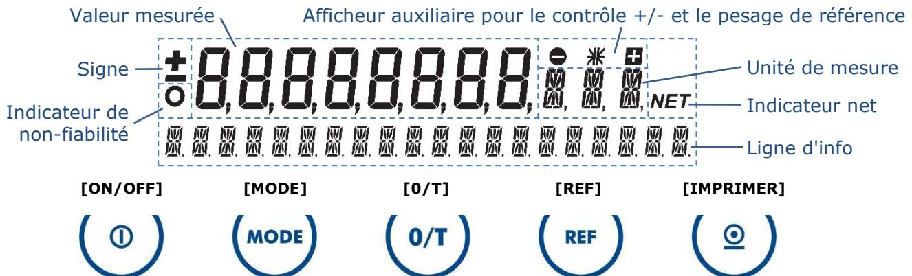
La valeur mesurée est stable dès que l'unité, par exemple "g", apparaît. L'indicateur de non-fiabilité s'allume pendant que la balance recalcule le poids de référence, par exemple pendant le comptage, ou lorsqu'elle est en métrologie légale et en phase de préchauffage.
