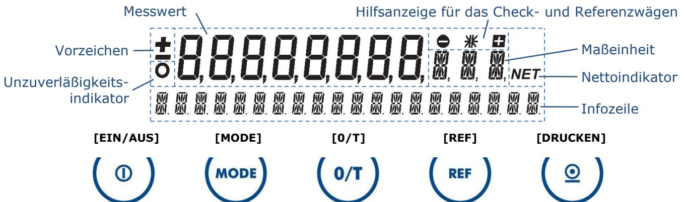
Der Messwert ist stabil, sobald die Maßeinheit, z.B. "g", erscheint. Der Unzuverlässigkeitss-indikator leuchtet auf, während die Waage z.B. beim Zählen die Referenzstückzahl neu berechnet, oder wenn sie geeicht ist und sich in der Aufwärmphase befindet.
